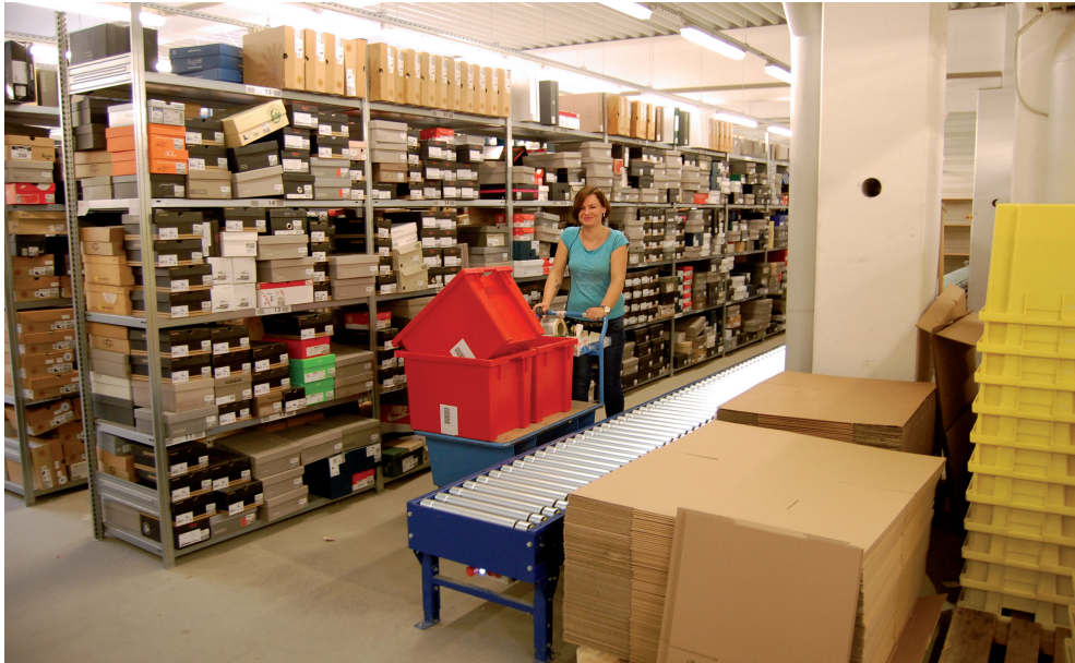
Bild 3 Verschiedenfarbige Kommissionierbehälter kommen zum Einsatz: Gelb für Einteil-Bestellungen - rot für Mehrteile-Bestellungen.
